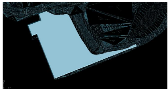
Escavo alla - 3,00 m s.l.m.m. a ridosso della diga di sopraflutto
